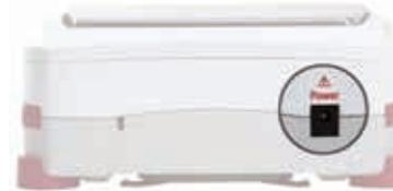
Um die Waage zu nivellieren, verstellen Sie die Daumenräder, bis die Libelle zentriert ist. Siehe den Nivellierungshilfebildschirm im Informationsmenü.
